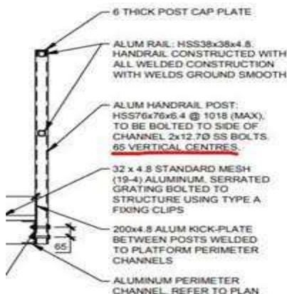
R2 : Les 65 centres verticaux font référence à l'espacement des boulons indiqué ci-dessous. Espacement de 65 mm entre les boulons, disposés verticalement et centrés sur l'âme du canal C152 x 64 x 6,4.
