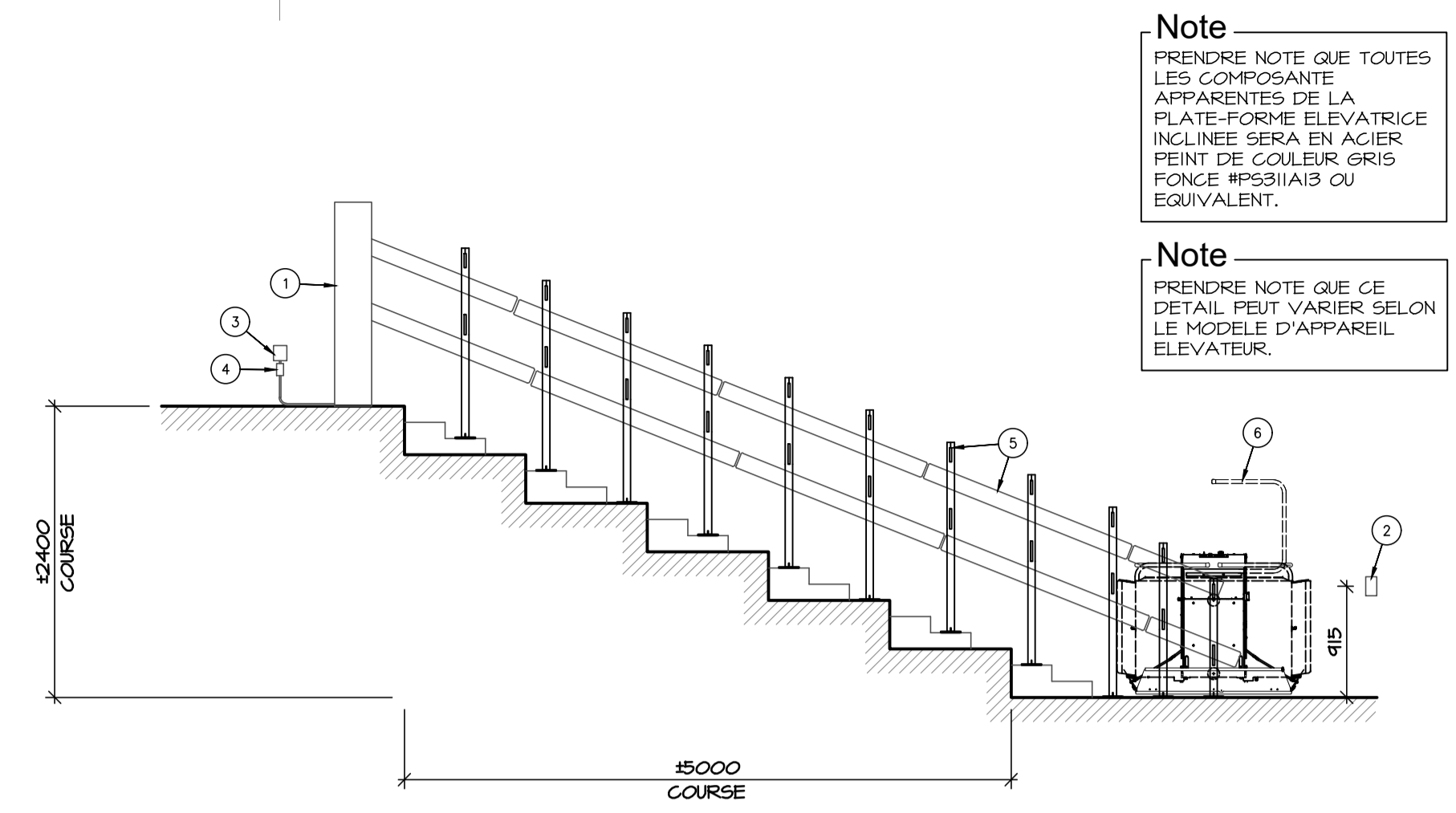
1 COUPE DE LA PLATE-FORME ELEVATRICE A-1 1 : 50
