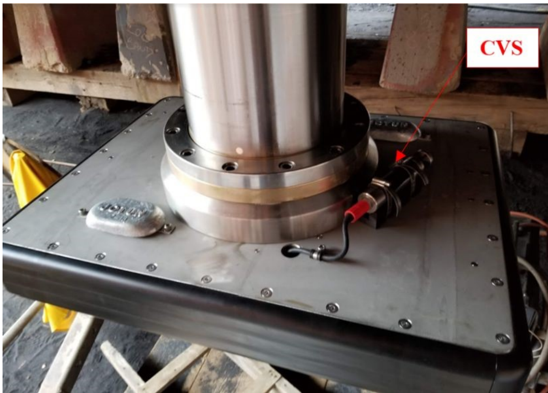
Figure 1: Configuration de montage du CVS sur l'ensemble du module de transducteur
