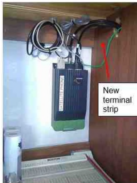
Figure 17.4-25 : Émetteur-récepteur Iridium
