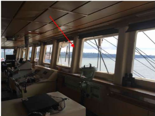
1 Matériau contenant de l'amiante Timonerie — Local 501 — Cadre de fenêtre — , — Revêtement texturé — Quelques débris à nettoyer — N/A Chantal.Soulard - 2020-06-29 13:38
