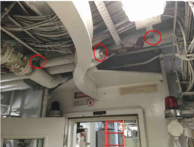
45 Matériau contenant de l'amiante Moteurs — Salle des moteurs principaux — Tuyauterie — Eau chaude — Magnésie — Bon — N/A Chantal.Soulard - 2020-06-29 16:51
