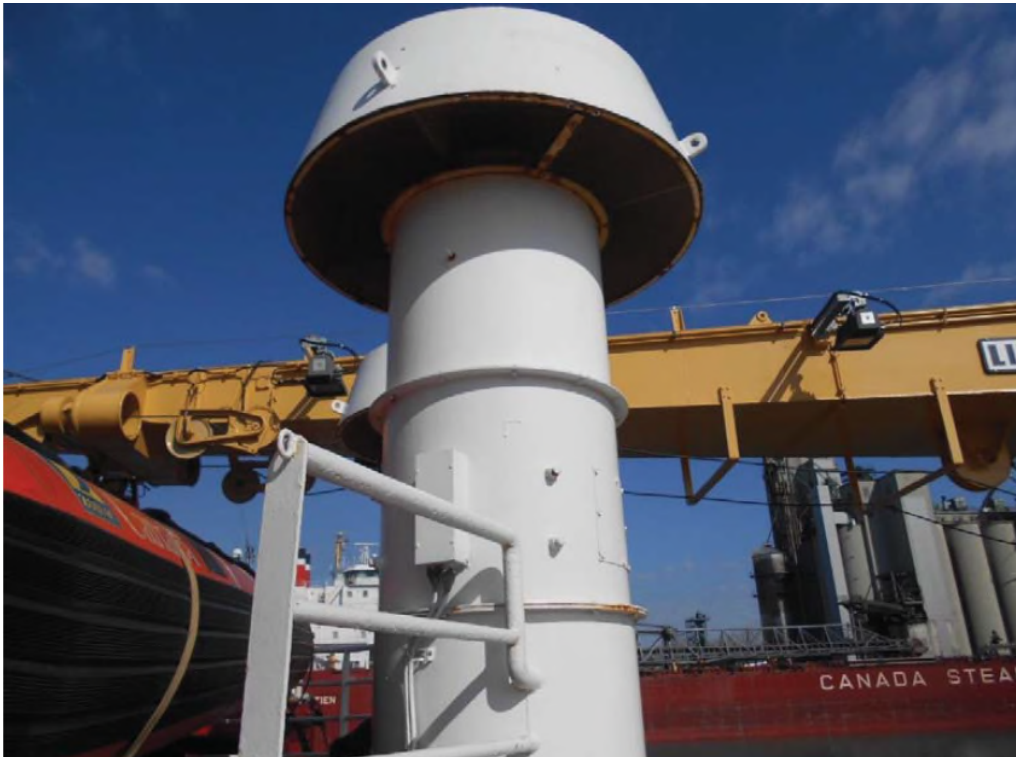
Figure 16.3-3 : Photographie du ventilateur d'alimentation dans la salle des machines (SF-5 ou SF-6)
