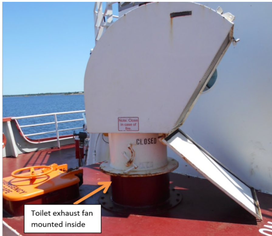
Figure 16.3-11 : Photographie des ventilateurs axiaux d'évacuation des toilettes (EF-4)
