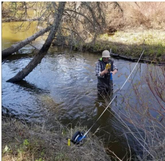
Figure 2 : Un technologue effectuant une mesure hydrométrique près de l'embouchure du site 07DA040 Big Creek.
