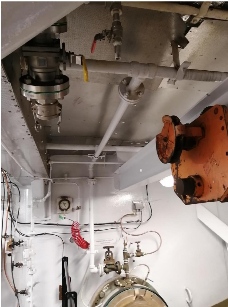
Conduite d'eau de refroidissement existante vers le tube d'étambot bâbord
