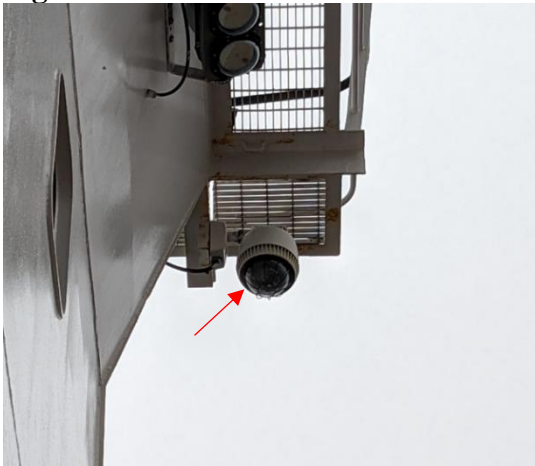
Caméra du mât arrière – Axis Q6054-E
