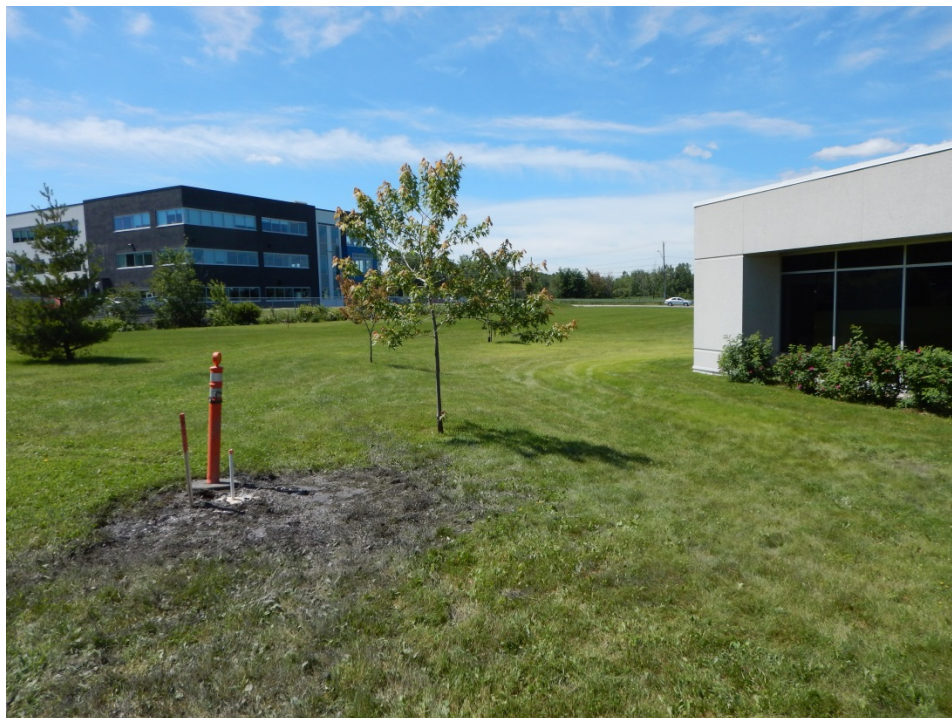
Photo 1 : Emplacement du forage F-15-01 et vue du piézomètre installé
