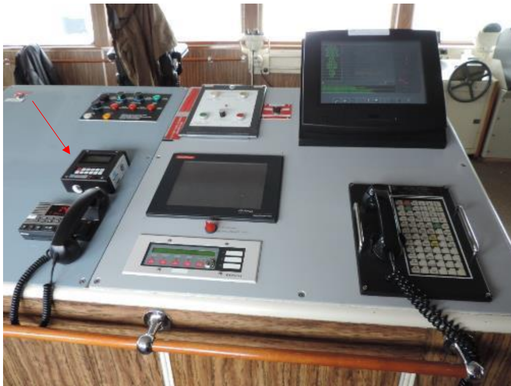
Figure 1: L'unité d'opérateur existante doit être remplacée par une nouvelle unité d'alarme de pont
