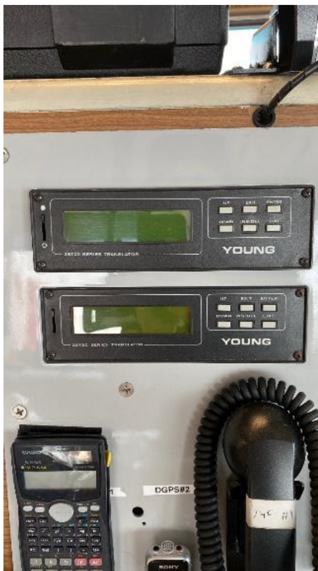
Figure 17: Le traducteur de vent existant à supprimer dans la table à cartes
