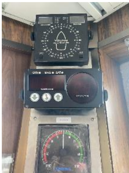
Figure 15: Répéteur numérique dans l'aile bâbord (à conserver en place)
