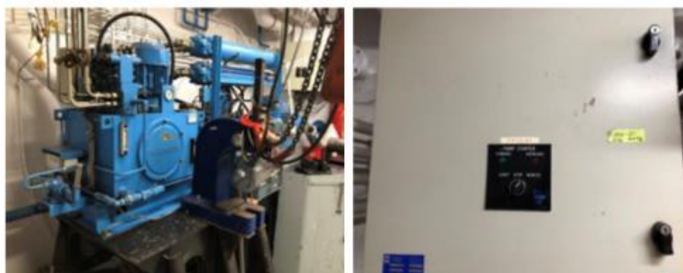
Bloc d'alimentation hydraulique du propulseur arrière et armoire de commande (salle des moteurs de propulsion)
