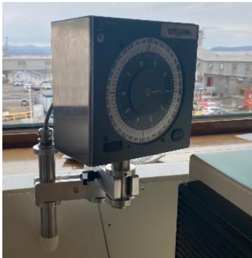
Figure 10: Répéteur de compas de la console centrale à remplacer (L'entrepreneur doit maintenir le bras pivotant et la boîte de montage en place)
