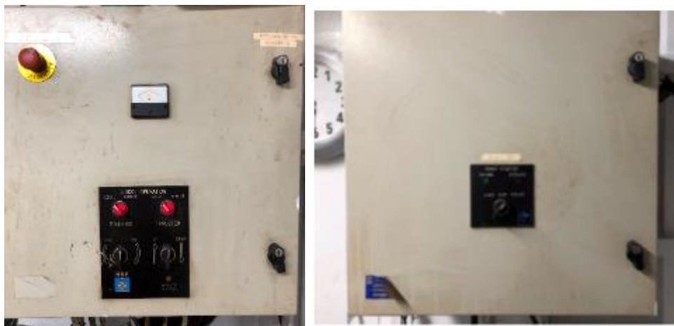
Armoires de commande du propulseur avant (compartiment du propulseur avant)
