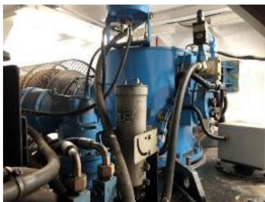
Boîte de vitesses supérieure du propulseur avant (compartiment du propulseur avant)
