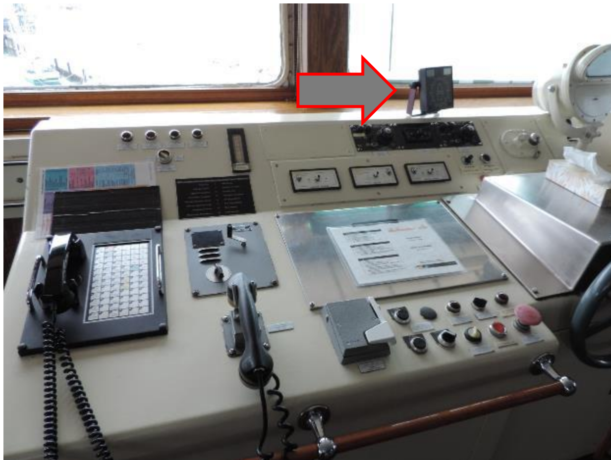
Figure 19: L'affichage de vent du timonier doit être remplacé par une nouvelle unité
