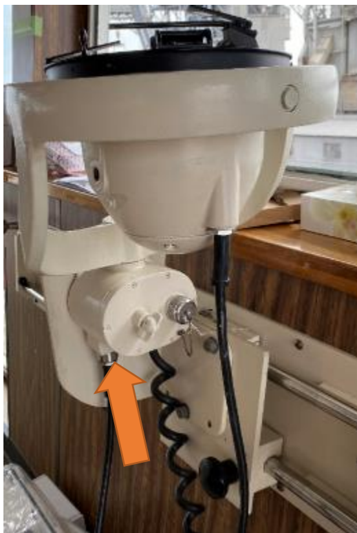
Figure 14: Boîte à bornes de répéteur de compas
