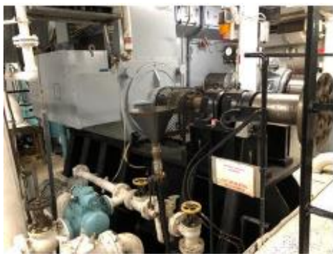
Moteur d'entraînement électrique arrière Elettra (Salle des moteurs de propulsion)
