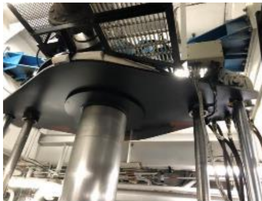
Propulseur arrière (compartiment du propulseur arrière)
