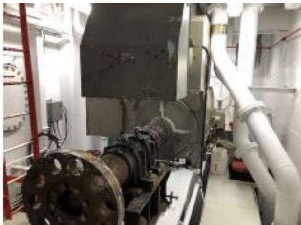
Moteur d'entraînement électrique avant Elettra (compartiment des propulseurs avant)
