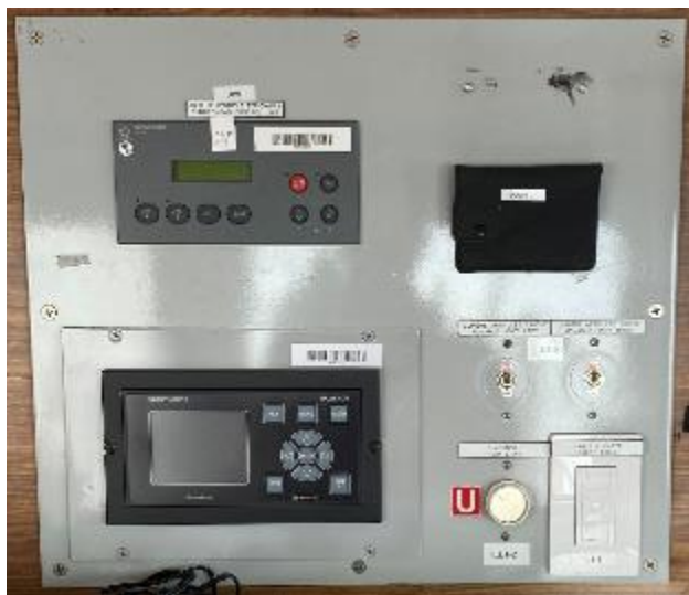
Figure 8: Unité de l'opérateur du gyrocompas à retirer
