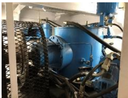
Boîte de vitesses supérieure du propulseur arrière (compartiment du propulseur arrière)
