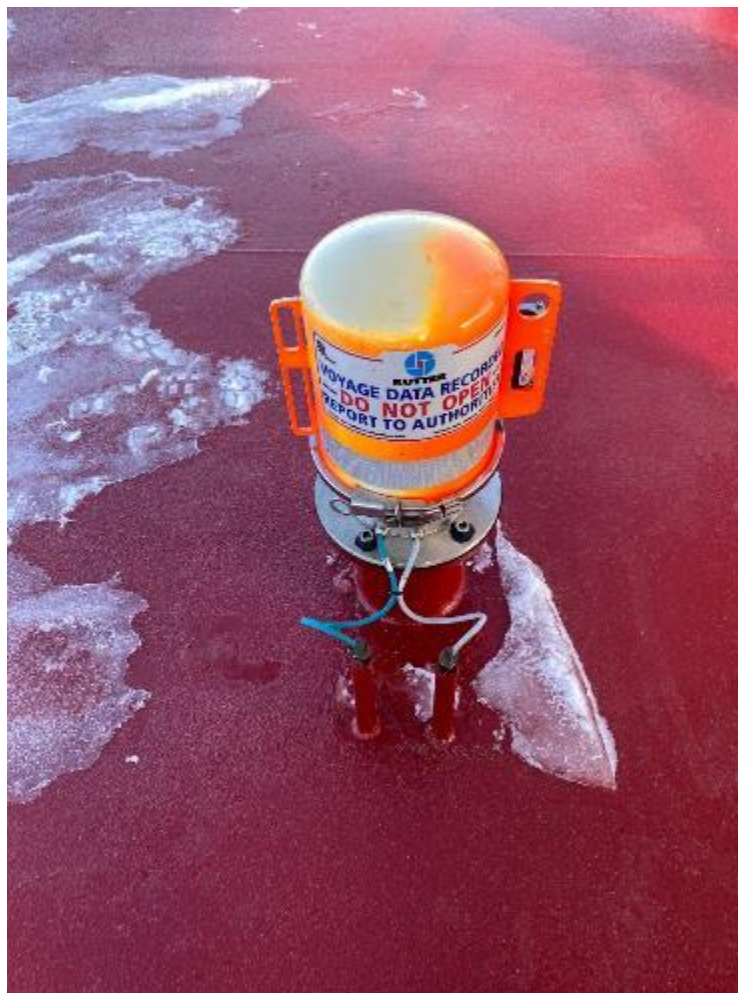
Figure 3 Capsule fixe existante à remplacer. Piédestal à remplacer également.
