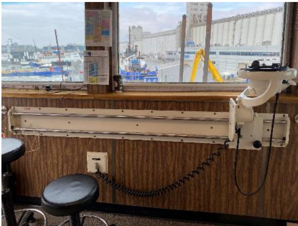
Figure 12: Répéteur de compas d'aile bâbord sur rail
