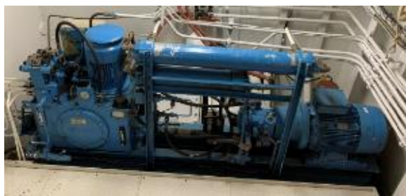
Bloc d'alimentation hydraulique du propulseur avant (compartiment du propulseur avant)
