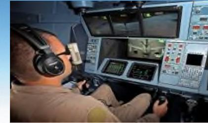
**Console de ravitaillement en vol** pour commander et surveiller les opérations de ravitaillement en vol avec imagerie 3D
