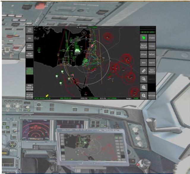
Scénario tactique intégré aux écrans du poste de pilotage
