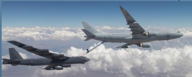
**Perche de ravitaillement en vol** pour ravitailler en vol les aéronefs dotés d'une prise à cet effet (p. ex., F-15, F-16, F-35, MRTT, AWACS)
