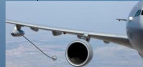
**Deux (2) nacelles sous les ailes** pour ravitailler les chasseurs avec une perche
