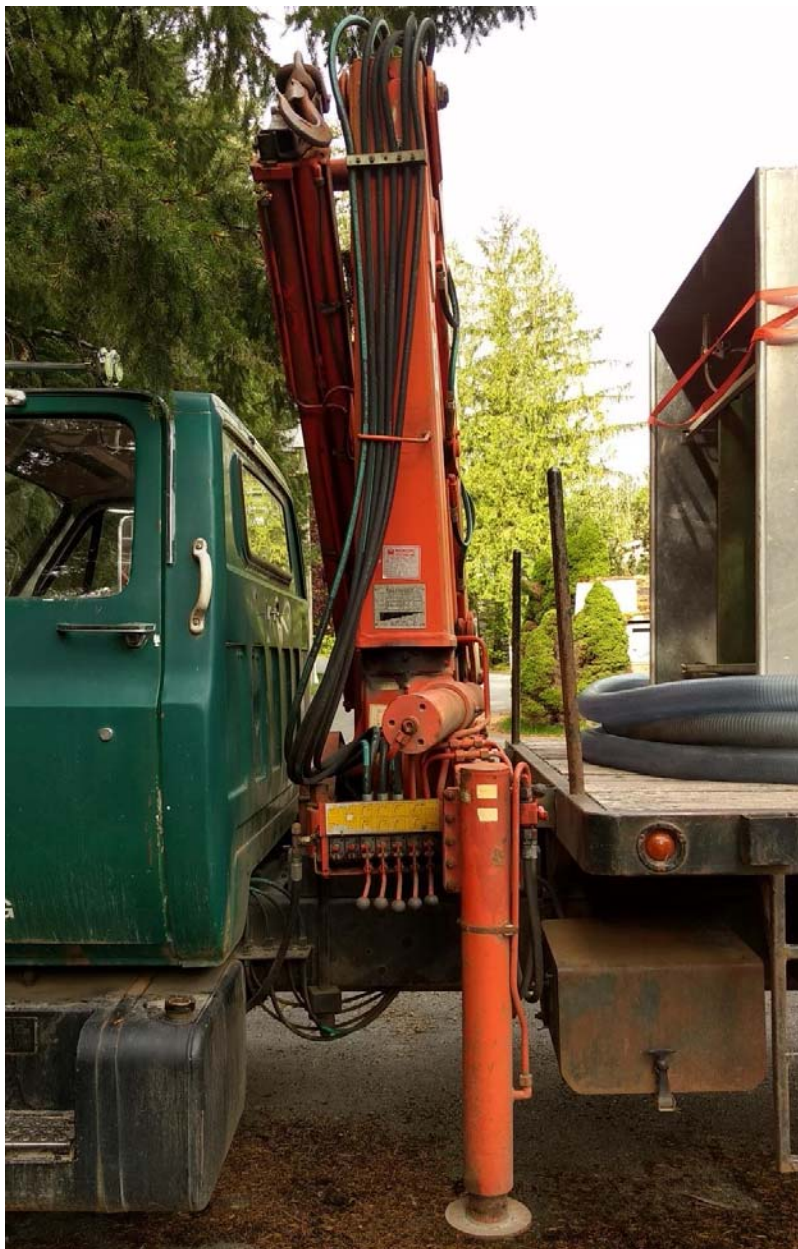
Photo 002 – Installation actuelle de la grue articulée
