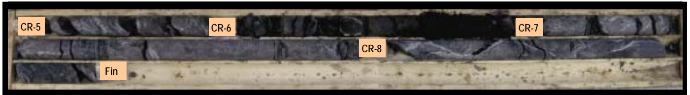
PHOTOGRAPHIE # 6: Carottes de roc du forage TF-03-11 (CR-5 à CR-8).
