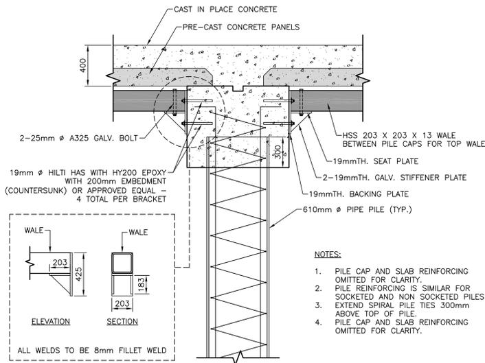
DETAIL - PILE REINFORCING AT PILE CAP
