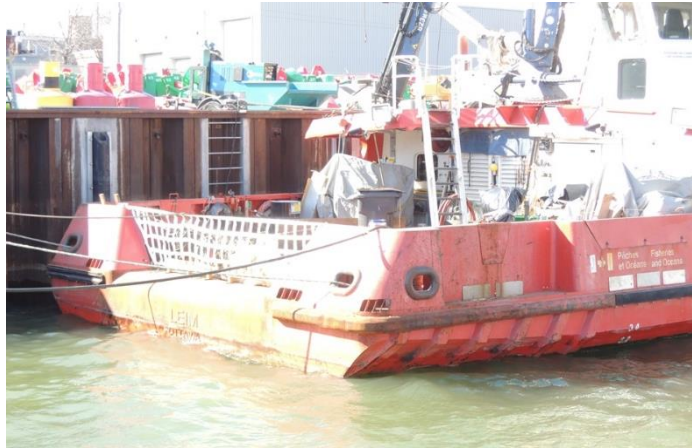
Figure 1 : Ruban de protection et protections de chalut existant (6 pièces/côté) P&S
