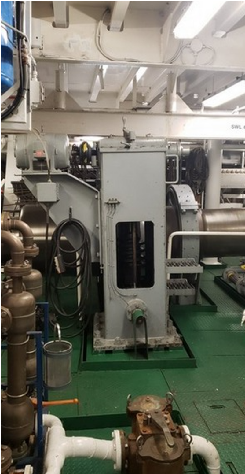
Photo 8 – Vireur bâbord (en regardant vers le milieu du navire et le côté tribord/extérieur)
