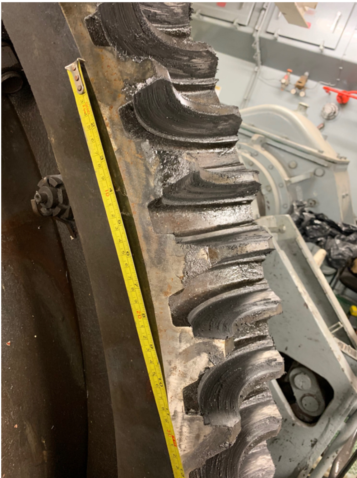
Photo 2 – Usure de la roue d'engrenage tribord en fonte
