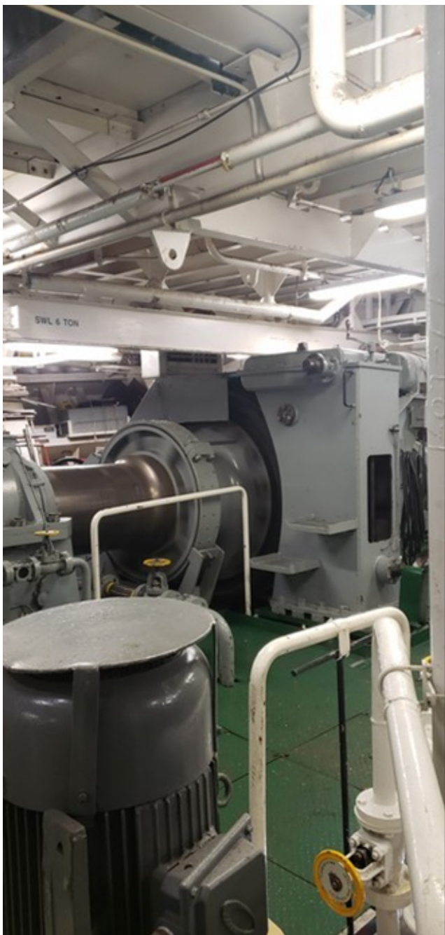
Photo 11 – Vireur tribord (en regardant vers l'arrière et le côté tribord/extérieur)
