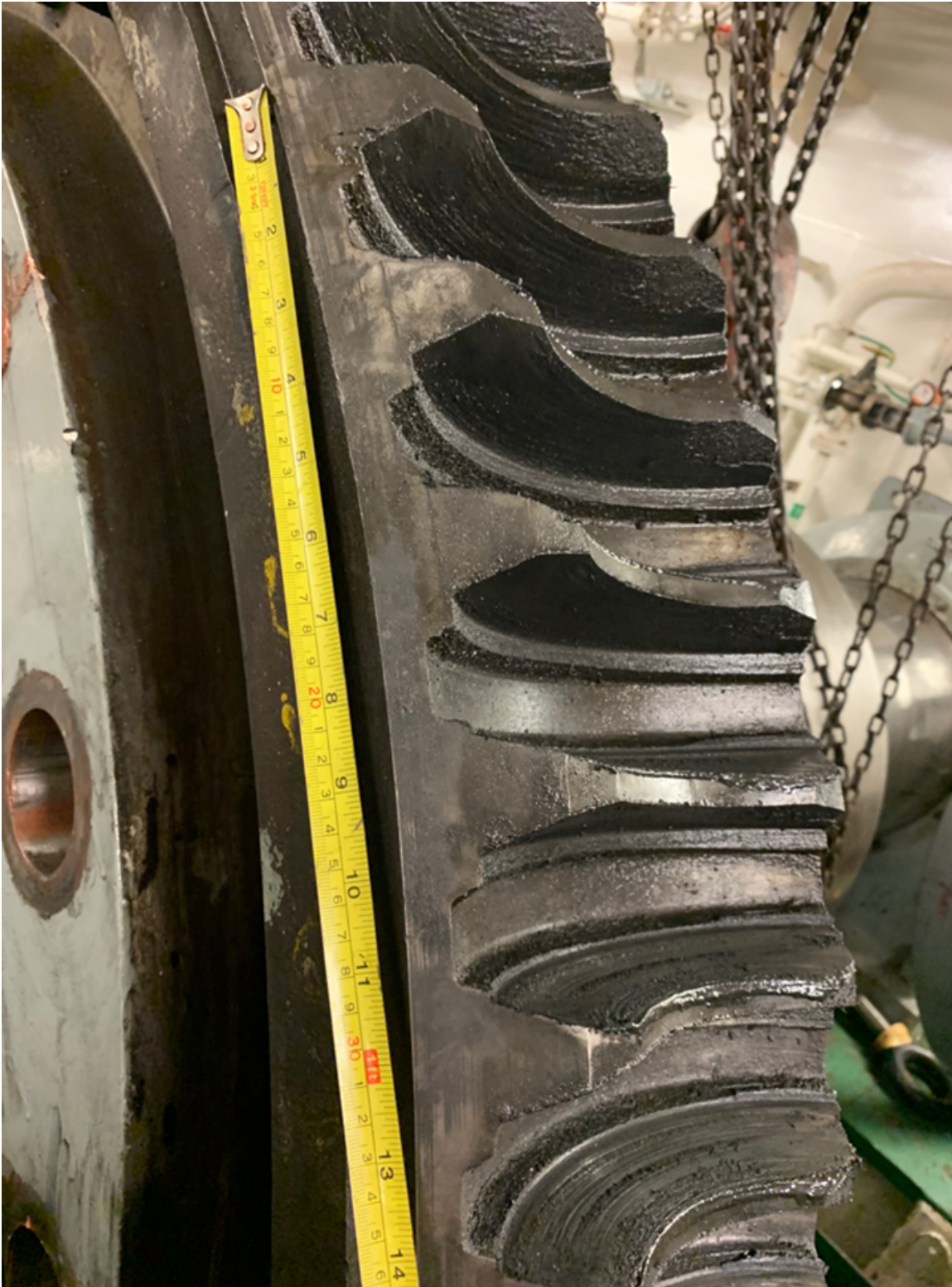
Photo 1 – Usure de la roue d'engrenage bâbord en fonte
