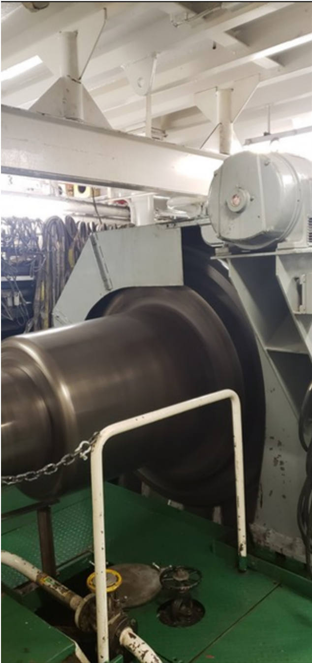
Photo 4 – Vireur de l'arbre porte-hélice bâbord (en regardant vers l'avant et le côté tribord/extérieur)
