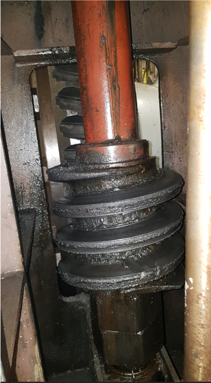
Photo 3 – Vue de l'engrenage à vis sans fin bâbord depuis la voie d'accès (le côté tribord est identique)
