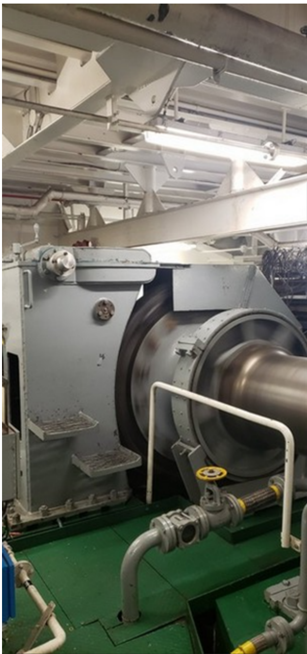
Photo 6 – Vireur bâbord (en regardant vers l'arrière et le côté tribord/extérieur)
