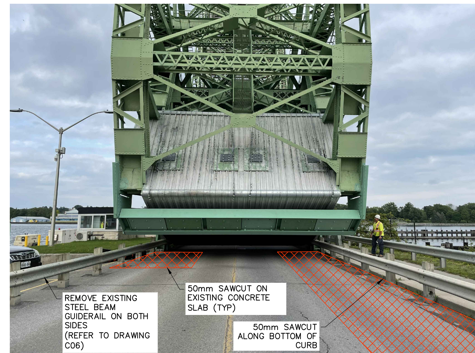
CONCRETE SLAB -REMOVALS N.T.S.
