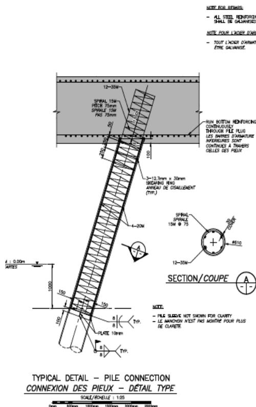
**Réponse 9 :** La plaque 10mm est soudée à l'armature de connexion de tête du pieu mais n'est pas soudée au pieu. Celle-ci est par conséquent indépendante du pieu et permet de contenir le béton dans la zone indiquée aux plans (au-dessus de l'élévation -1.00m). Les soudures visibles sur le détail sont entre la plaque 10mm et la cage d'armatures.
