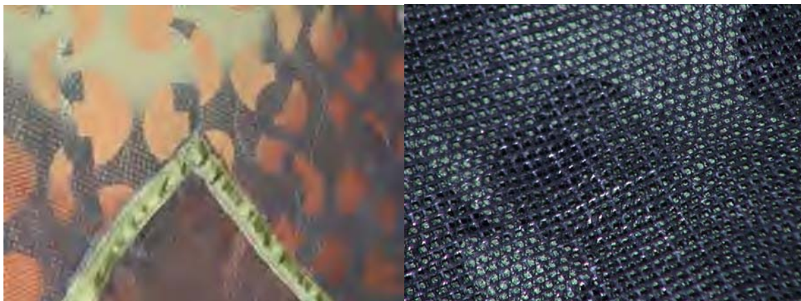
Figure 2 – Exemple de tissu de camouflage convectif 3D composé de 2 couches de tissu Polyester tissé cousu ensemble de manière précise. Côté recto à gauche et verso à droite
