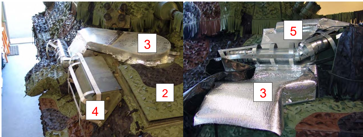
Figure 9 – Exemples de composants mécaniques pour dévier l'air de refroidissement en provenance des ventilateurs de refroidissement (3), pour recouvrir les émissions thermiques directes des pots d'échappement (4) et pour dévier les gaz chauds des pots d'échappements (5).
