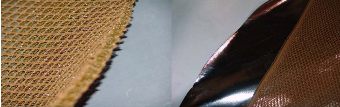
Figure 7b) – Couche intérieure du bouclier thermique avec isolant et couche de séparation (composante bouclier thermique)
