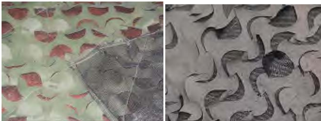
Figure 5 : Exemple de tissu de camouflage mobile convectif en 3D composé de 2 couches de tissu distinct tissé (Version forêt à gauche et version désert à droite)
