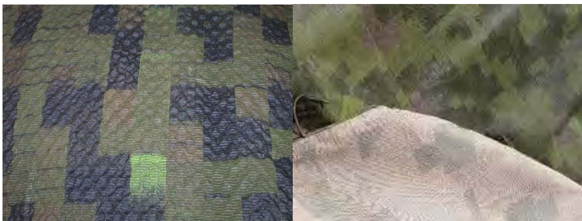
Figure 3 – Exemple de tissu de camouflage convectif réversible 2D composé de 3 couches de tissu Polyester tissé
