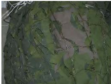
Figure 1 – Exemple de tissu de camouflage conventionnel en plastique PVC composé d'un cordage de base en Nylon attaché par un clip de plastique à un tissu laminé PVC
