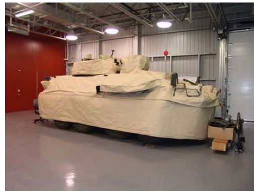
Figure 8 – Exemple d'un véhicule blindé Coyote recouvert d'une couche de tissu de bouclier thermique et de toile de convoyeur au-dessus des roues du véhicule
