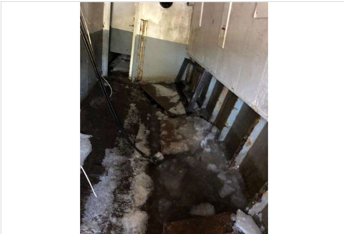
13. Accès à tribord à la zone de la voûte - inondation contre le flanc
