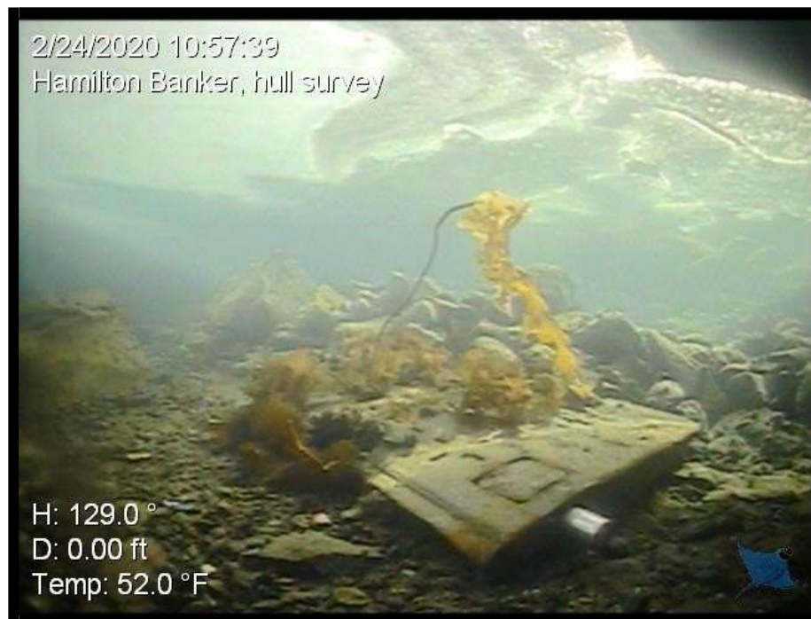
Figure 8 - Gouvernail délogé près de l'emplacement arrière.
