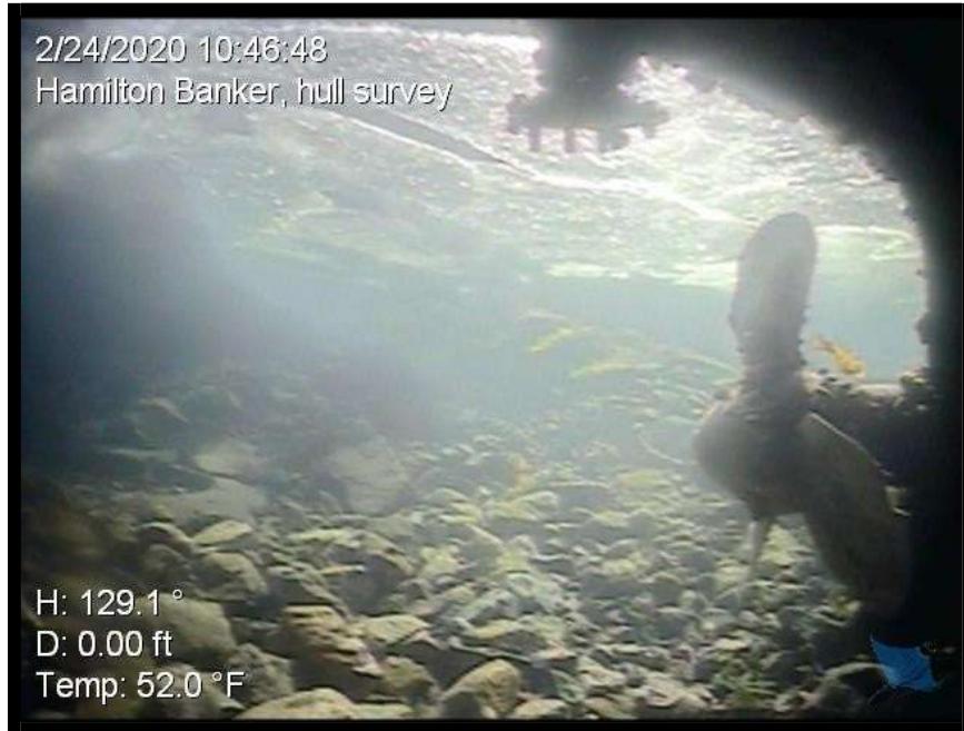
Figure 3 - Zone de poupe montrant l'hélice endommagée.
