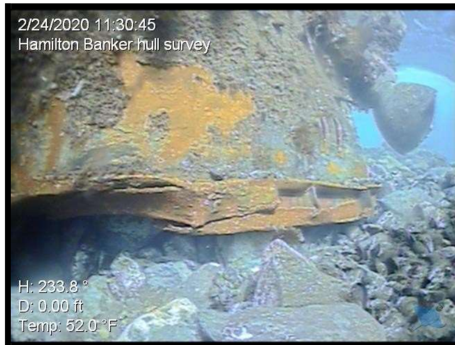
Figure 10 - Emplacement arrière montrant des dommages à la quille.
