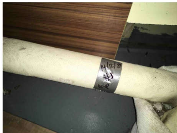
3 Amiante échantillon Pont de navigation — Crawl space Audrey.Corbail - 2021-12-14 11:58 Échantillon 3a
