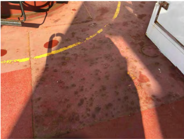
7 Peinture (Pb+Hg) Pont des embarcations — N/A — Rouge — Plancher — N/A — Écaillé Chantal.Soulard - 2021-03-25 15:35
