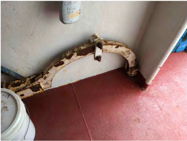
6 Peinture (Pb+Hg) Pont des embarcations — Corridor — Blanc — Élément mécanique — Clé pour hélice — Écaillé Chantal.Soulard - 2021-03-25 14:05
