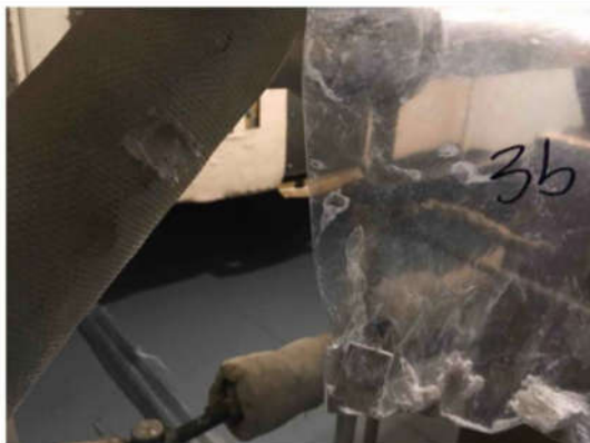
3 Amiante échantillon Pont de navigation — Crawl space Audrey.Corbail - 2021-12-14 11:59 Échantillon 3b (unité de chauffage timonerie : alimentation vapeur). Canevas et pâte cimentaire de l'unité de chauffage timonerie
