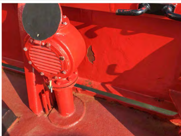
11 Peinture (Pb+Hg) Pont supérieur — N/A — Rouge — Murs — N/A — Écaillé Chantal.Soulard - 2021-03-25 15:53
