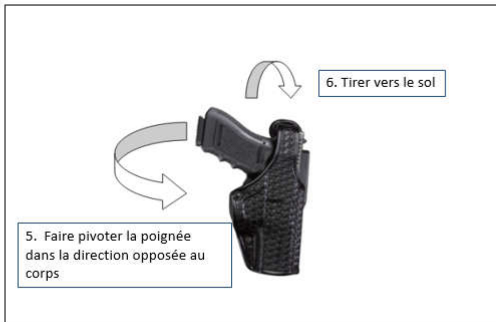
Figure 2 : Directions supplémentaires d'insertion de l'arme dans l'étui et essai d'impact
