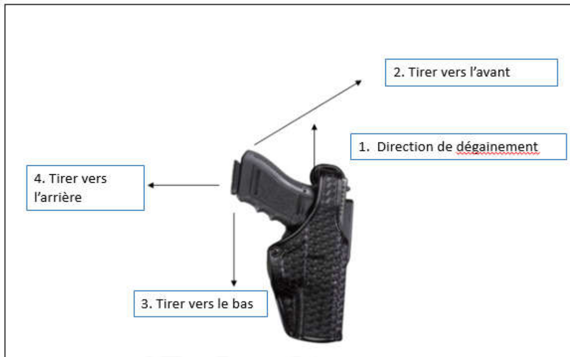
Figure 1: Directions d'insertion de l'arme dans l'étui et essai d'impact
