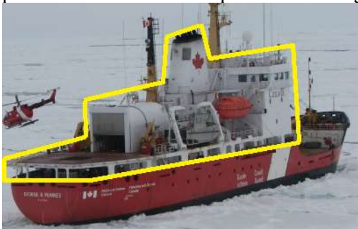
Mise en évidence de toute la zone de la Superstructure dont les revêtements seront renouvelés dans le présent article.
