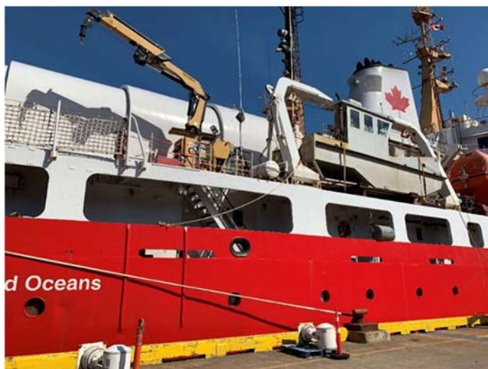
Vue latérale du pont supérieur. Les sections internes et externes (blanches), ainsi que la zone complète de la tête de pont, doivent être entièrement nettoyées, préparées et revêtues comme indiqué dans le présent article.
