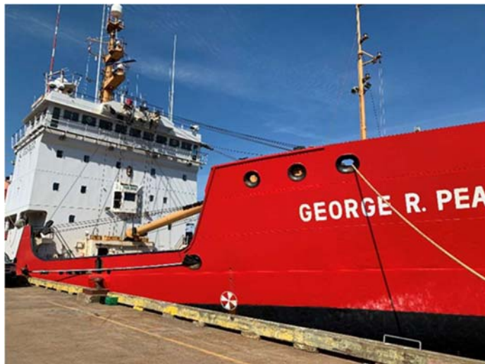
Vue avant – L'ensemble de la superstructure, à partir de la cloison avant du compartiment wire leads sur le pont principal, doit avoir les revêtements renouvelés.
