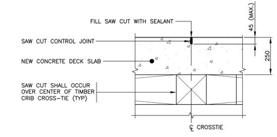
SECTION - CONTROL JOINT (TYP.) SCALE: 1:10
