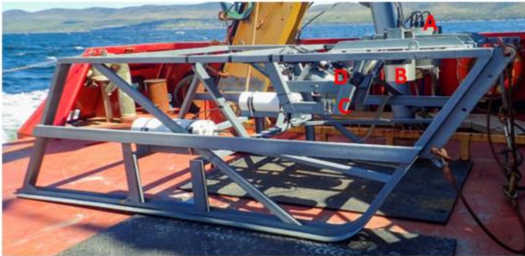
Figure 2 : Traîneau d'imagerie benthique
