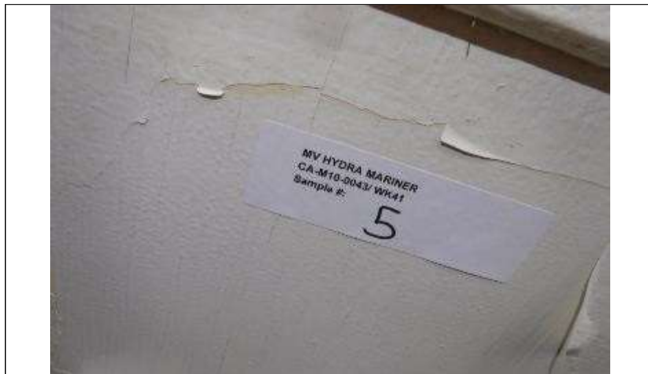
6. Échantillon 5 – Peinture intérieure plombifère.
