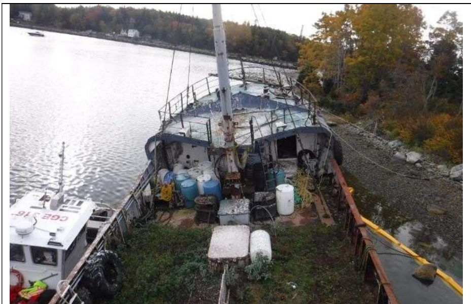
1. Végétation sur le pont
