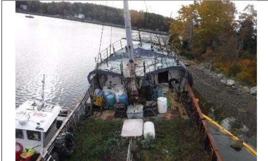
1. Végétation sur le pont.
