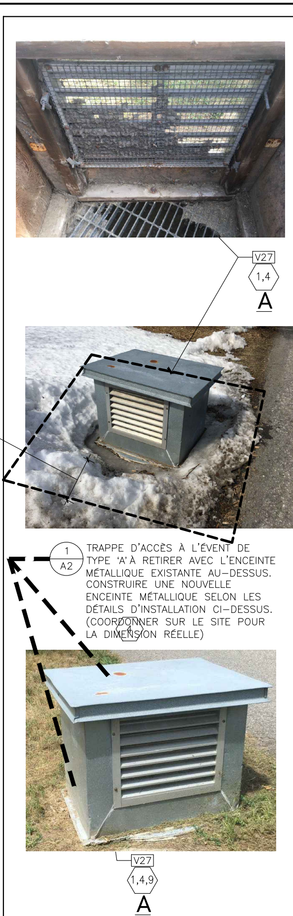
2 TRAPPE DE TYPE B AVEC GRILLE D'ACIER ET BORDURE DE BÉTON ÉCHELLE = NON À L'ÉCHELLE QTE : 1
