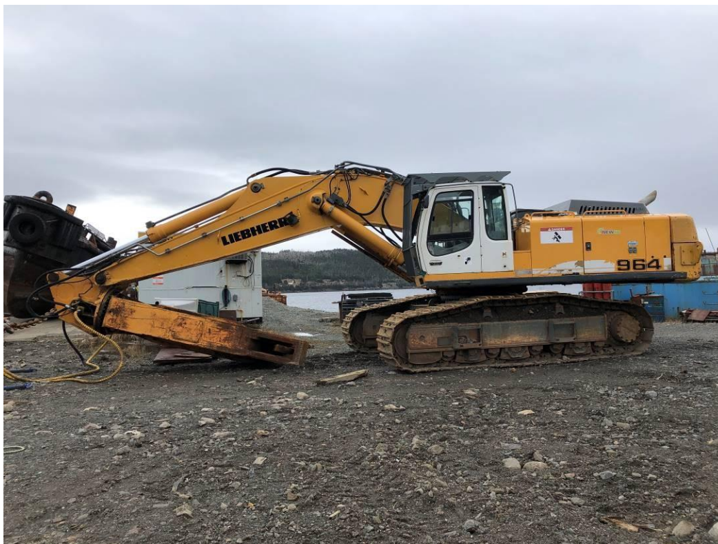
10. Excavatrice équipée de cisailles à métaux
