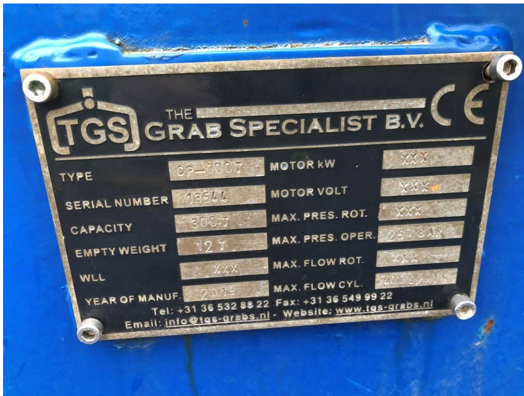
8. Plaque signalétique indiquant la capacité de l'extracteur de 300 MT
