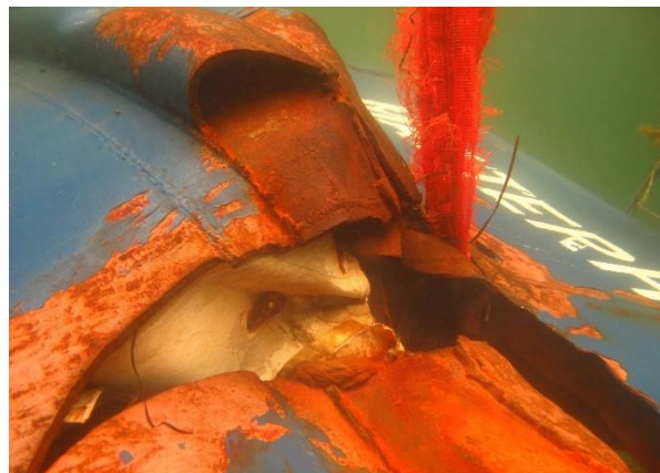
Affiche les dommages de la coque du côté tribord.
