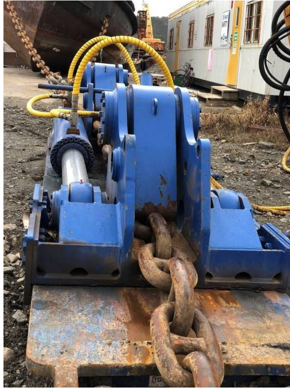
7. Extracteur à chaîne utilisé pour hisser les navires sur la « cale de halage »
