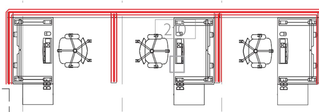
PANNEAUX DE POSTE DE TRAVAIL – 3 PUPITRES AU MILIEU DE LA PIÈCE (COLONNE ÉLECTRIFIÉE, CARREAUX DE TISSU ACOUSTIQUE DES DEUX CÔTÉS), PANNEAU DE SÉPARATION (TISSU/TISSU, NON ÉLECTRIFIÉ), 60 po. H X 60 po L.
