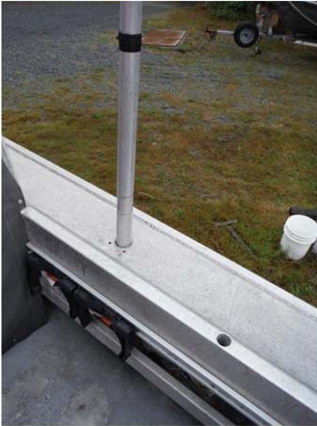
Image 5 : Image d'une insertion de tuyau pouvant accueillir un bossoir ou un poteau de vire-ligne
