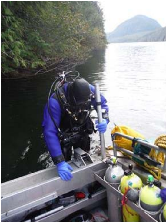
Image 4 : Photo d'un plongeur sur une échelle utilisant une barre d'appui à insertion de tuyau
