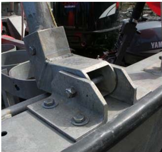
Image 1 : Conception de support boulonné pour échelle de plongée
