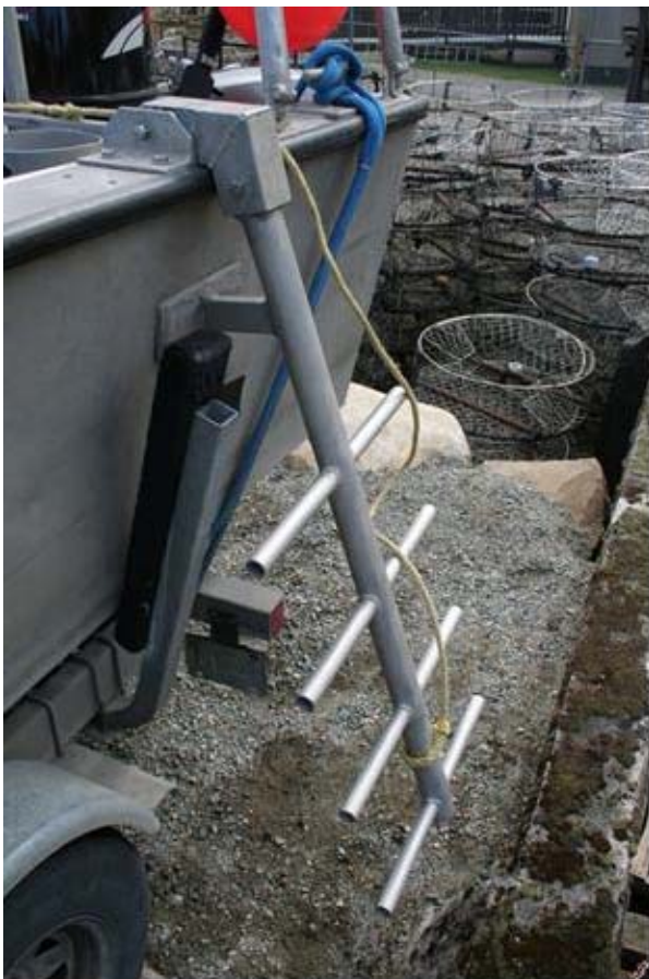
Image 2 : Conception d'échelle de plongée. Échelons de 10 po de longueur de chaque côté de la colonne vertébrale (largeur totale de 22 ¼ po) et échelons espacés de 10 po.
