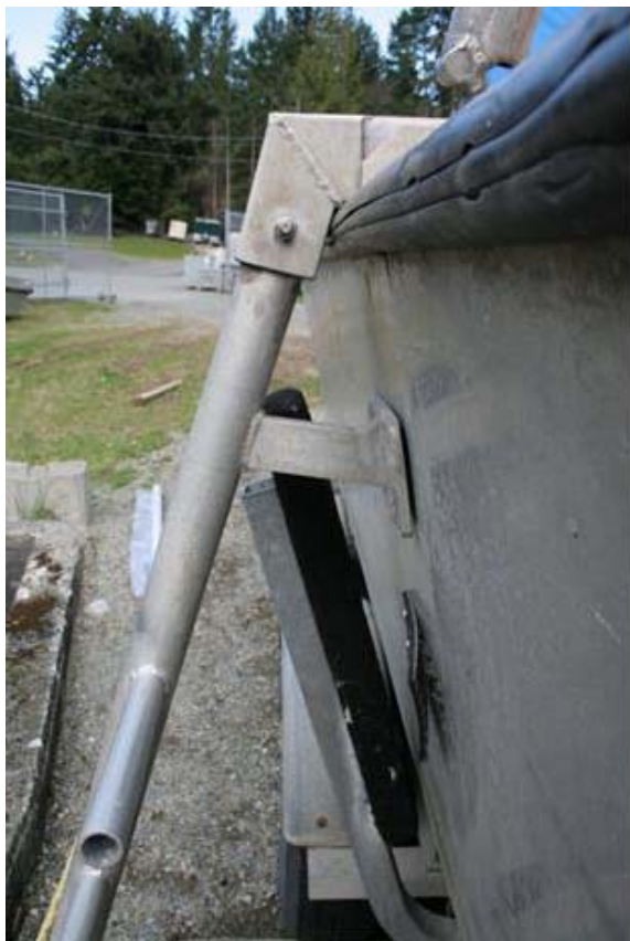
Image 3 : Poste d'échelle de plongée. L'angle entre l'eau et l'échelle est de 75 degrés. L'extrémité du poteau reposant sur la coque doit avoir un coussin pour répartir le poids (voir l'image 8).
