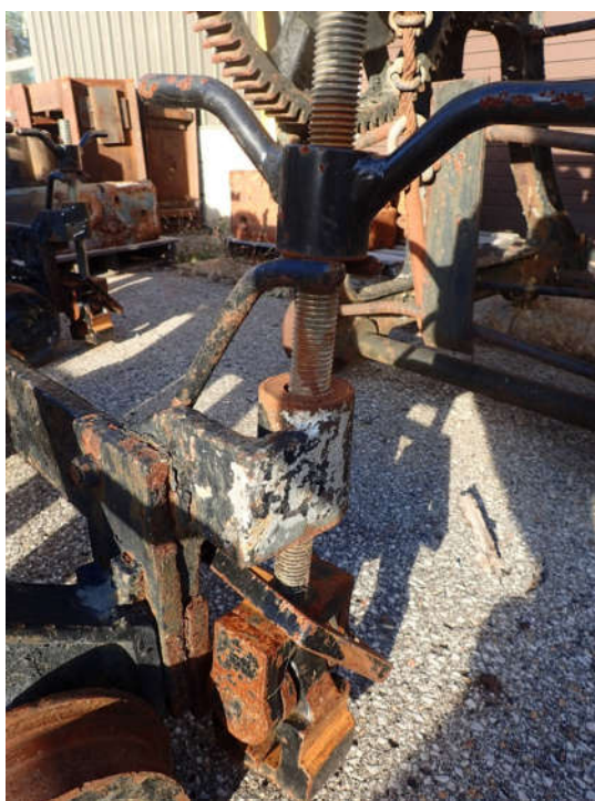
Figure 7.1 – Pinces à rails pour les rails de 40 lb
