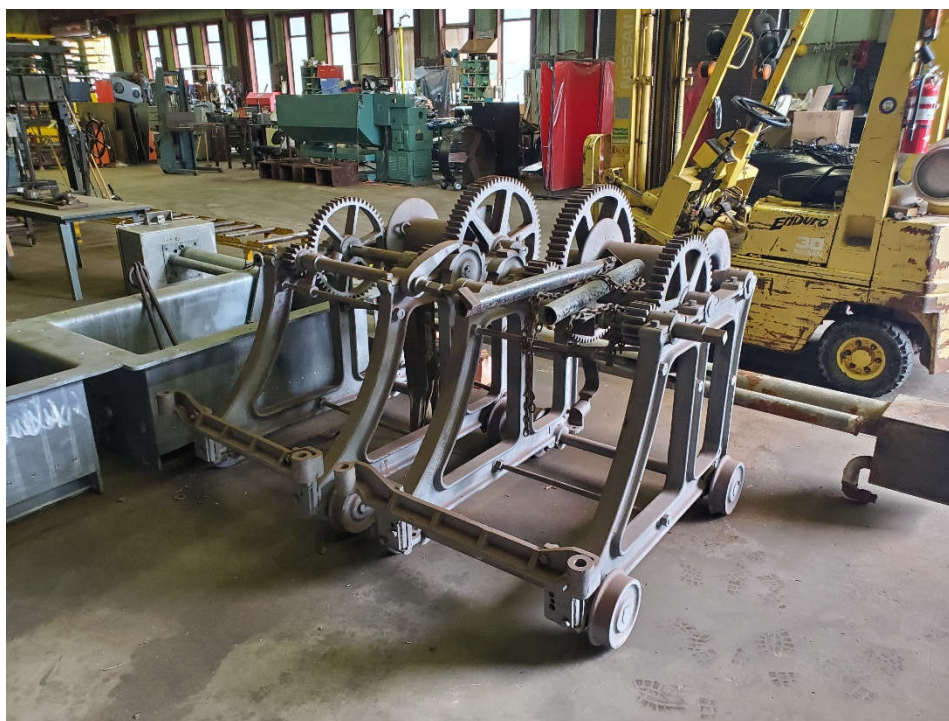
Figure 1.1 – Ensemble de treuil de crabe – sablé
