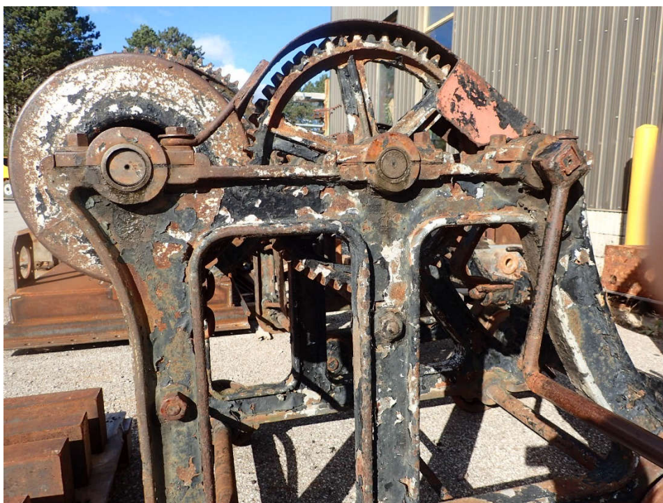
Figure 2.1 – État typique d'un treuil de crabe
