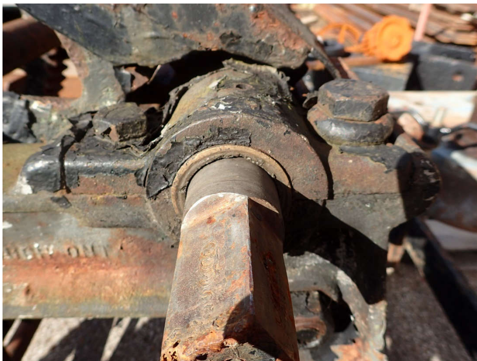
Figure 5.1 – Logement de paliers à semelle fendue avec douille en laiton
