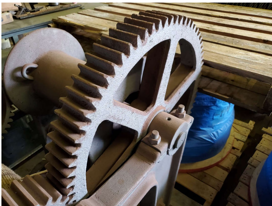
Figure 3.1 – Engrenage nécessitant un blindage ou une protection
