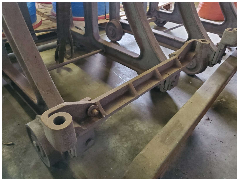
Figure 7.0 – Support pour les pinces à rails
