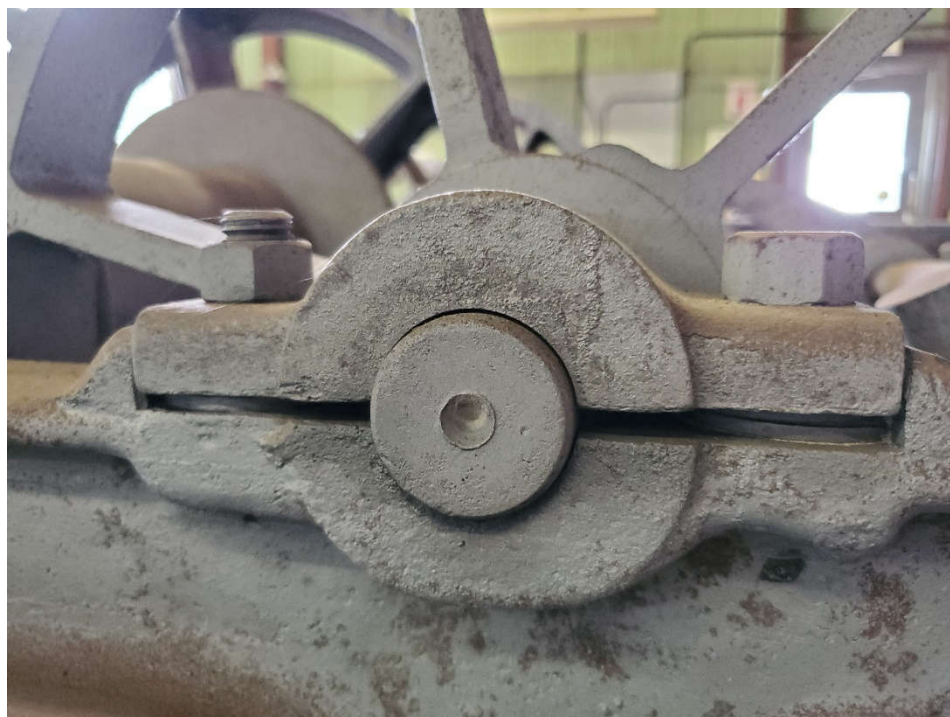
Figure 4.0 – Logement de paliers à semelle fendue installé à l’aide de cales
