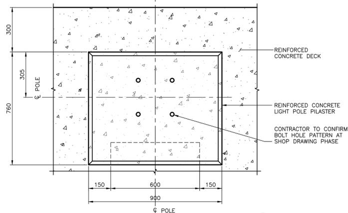
DETAIL - LIGHT POLE PILASTER
