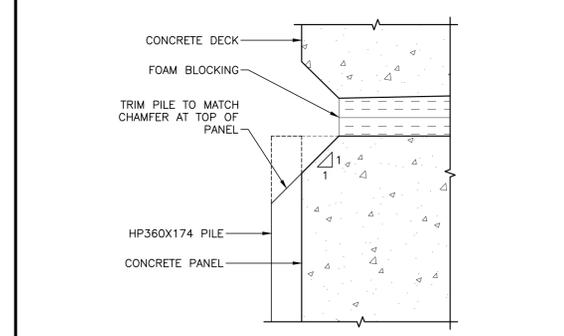
**DETAIL - PILE CHAMFER 13**
