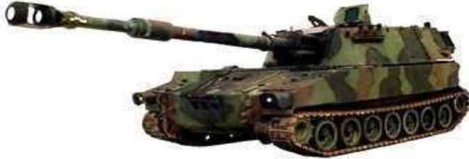
Dimensions du véhicule blindé M109 : 29,66 pi (9,04 m) de long, 10,34 pi (3,15 m) de large et 10,77 pi (3,28 m) de hauteur. Poids : 55 049,43 lb (24 970 kg).
