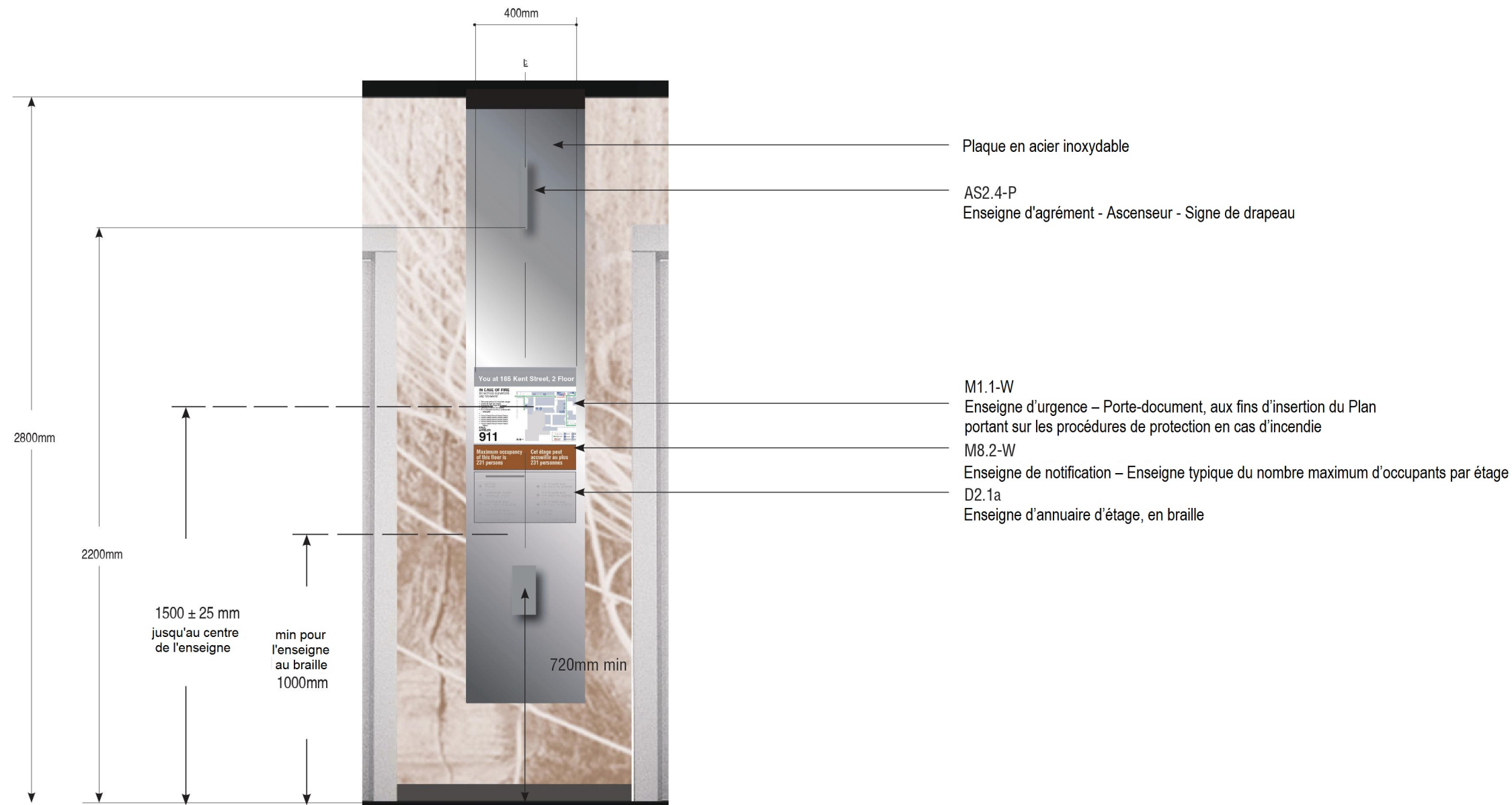
Lignes directrices de montage d'enseignes de foyer d'ascenseurs, de montage mural Échelle 1 : 5
