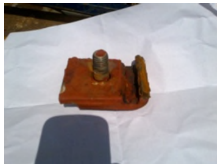
Exemple de patte de fixation de grille (cassée)
