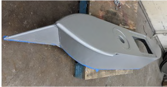
Photo n° 4 – Exemple d'un nouveau fuseau de transducteur avant l'installation
