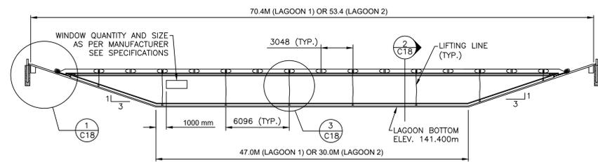
ELEVATION - BAFFLE CURTAIN
