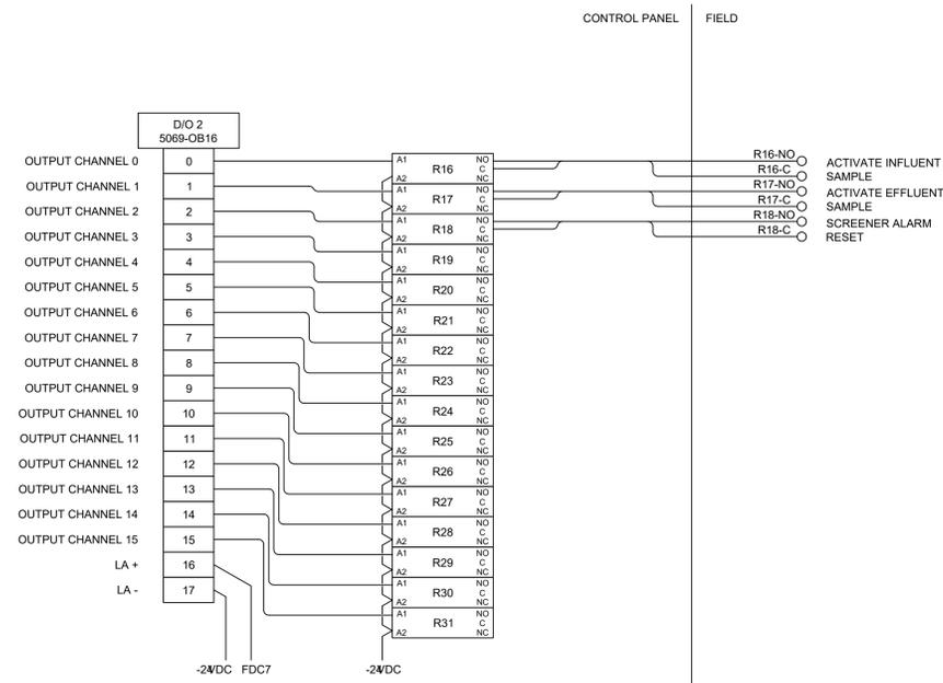
**RACK 1 SLOT 9 DISCRETE OUTPUT CARD 2**
