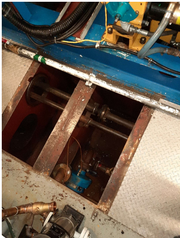
A.20 - Emplacement de la pompe à eau de refroidissement de la climatisation dans la salle des machines, côté tribord.
