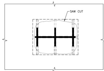
**3 SOFFIT DEEP SPALLING - PLAN**
