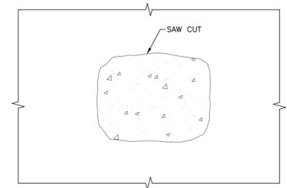
**2 SLAB SOFFIT SHALLOW SPALLING - PLAN**
