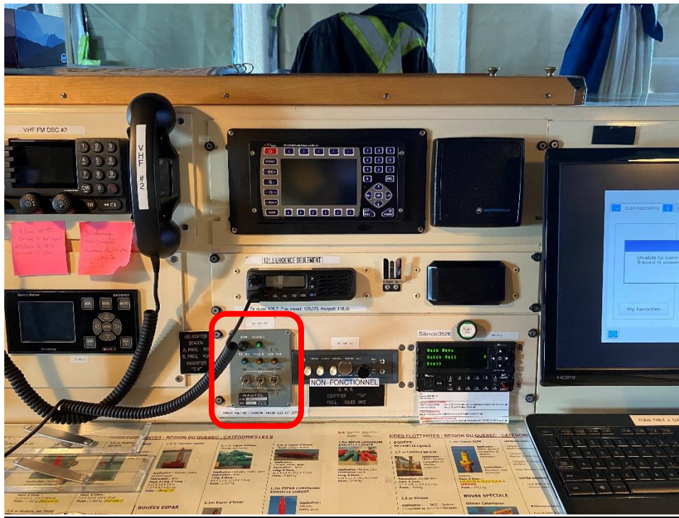
Figure 18.8-3 : Panneau de télécommande du NDB
