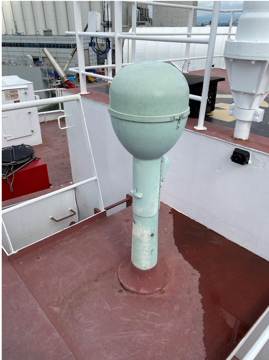
Figure 18.2-6 : Répéteur de relèvement sur socle (haut de la timonerie)
