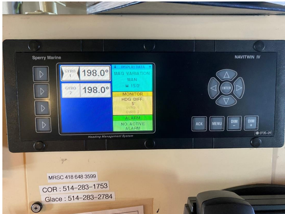
Figure 18.2-4 : UCA de gestion de cap (table à cartes)
