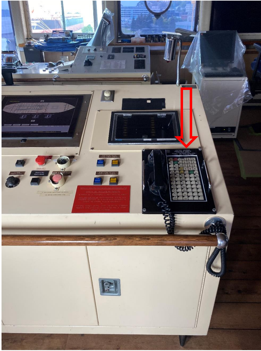
Figure 18.1-1 : Tête de commande du SCIN dans la timonerie
