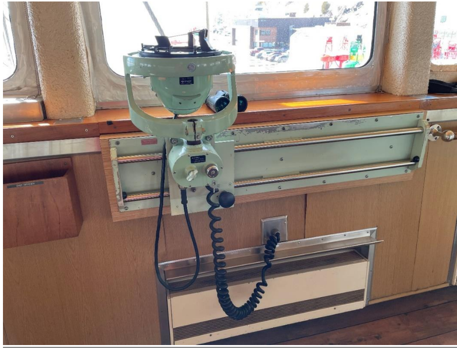
Figure 18.2-8 : Répétiteur de relèvement sur rail coulissant (centre avant)
