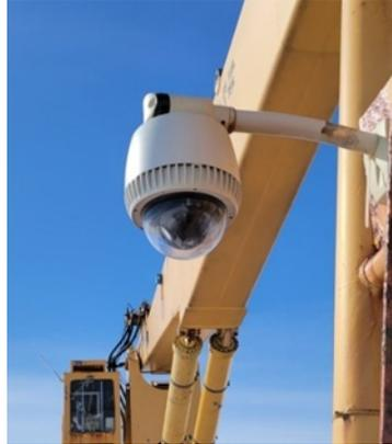
3.60.2.4. Caméra de la plage arrière – Axis Q6215-LE : La caméra de la plage arrière doit être montée sur la partie arrière de la plage arrière pour remplacer la caméra Bosch. Cette caméra doit être fixée au poteau existant au moyen de la monture fournie avec la caméra. L'alimentation de cette caméra sera assurée par un injecteur de puissance Axis T8154 Midspan muni d'un module T8612SFP (utilisant la fibre existante) qui doit être placé dans le compartiment du réservoir de carburant aviation.
