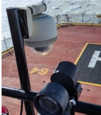
3.60.2.8. Caméra intérieure du hangar d'hélicoptère – Axis D201-S Q6075 VPIZ : La caméra intérieure du hangar d'hélicoptère est protégée contre les explosions et doit être montée sur la cloison du hangar d'hélicoptère pour remplacer la caméra America Dynamics actuelle. Cette caméra doit être fixée au support existant ainsi qu'au support fourni avec la caméra.
