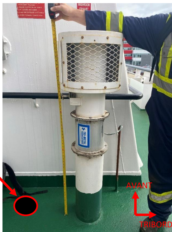
Figure 4 : Nouvel événement d'échappement à configurer et à installer comme illustré
