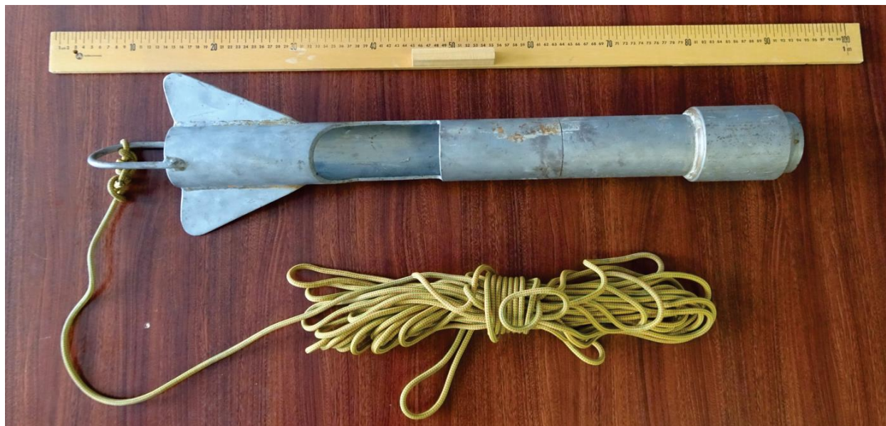
Figure 2. Échantillonneur de sédiments lacustres utilisé à la Commission géologique du Canada. L'appareil pèse 7,1 kg et prélève une carotte de 30 cm de sédiments lacustres, ce qui correspond à un poids de 1,2 kg de sédiments lacustres.
