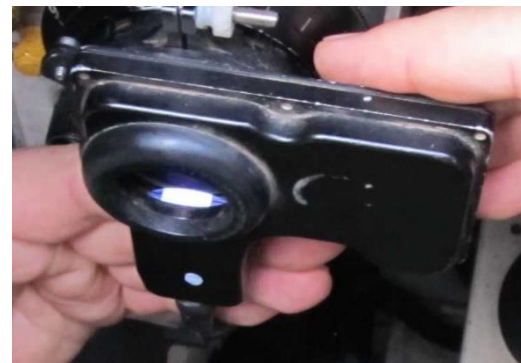
Unité de traceur de tir (simule le point d'impact du tir, donne une rétroaction au tireur)
