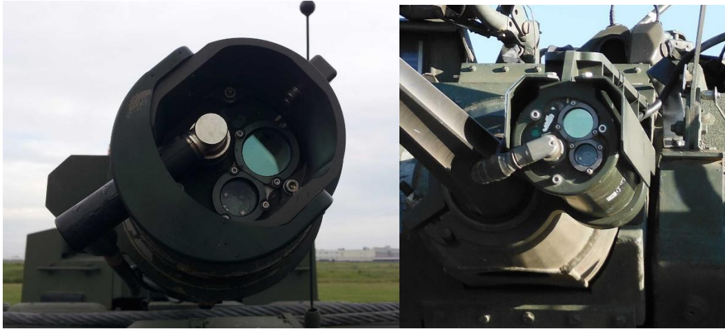
Unité de transmission laser Monté dans un canon de 120 mm (à gauche) Monté par un canon de 25 mm (à droite)
