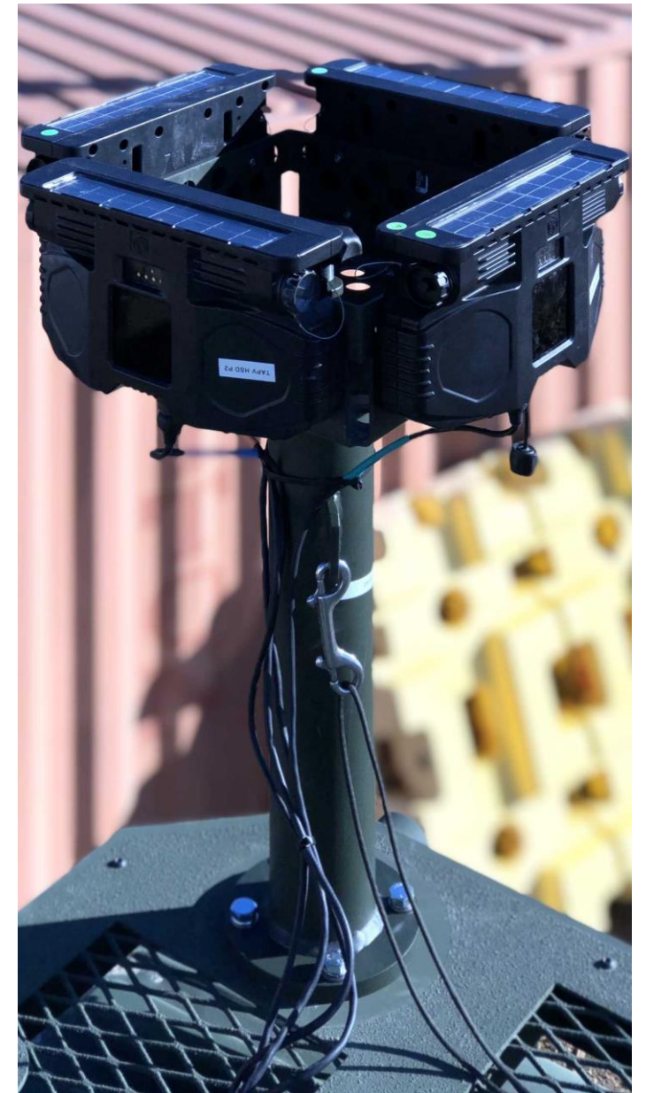
Mât avec quatre détecteurs haute sensibilité et lumières intégrées
