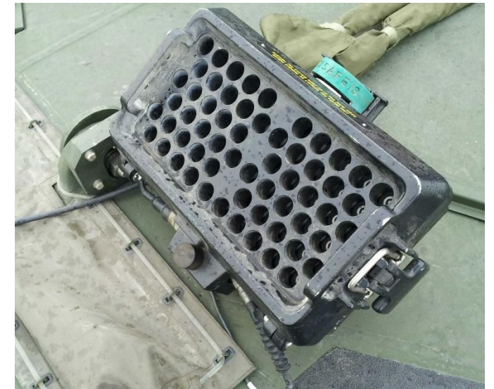
Simulateur de signature d'arme principale - Chars Leopard 2 uniquement
