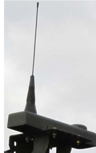
Antennes réseau de communication de données et de géo-positionnement par satellite (GPS)
