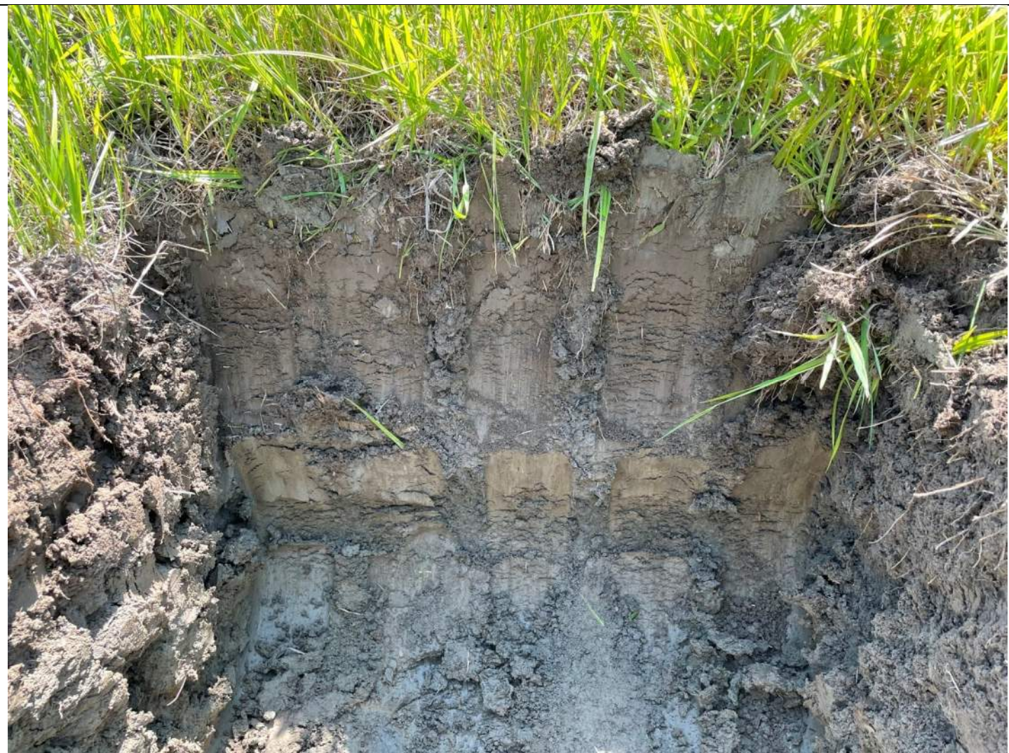
Figure 6 – Excavation géotechnique démontrant une argile limoneuse à travers le site.
