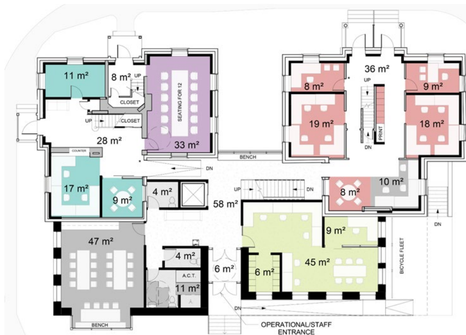
Figure 5 : plans indicatifs du rez-de-chaussée
