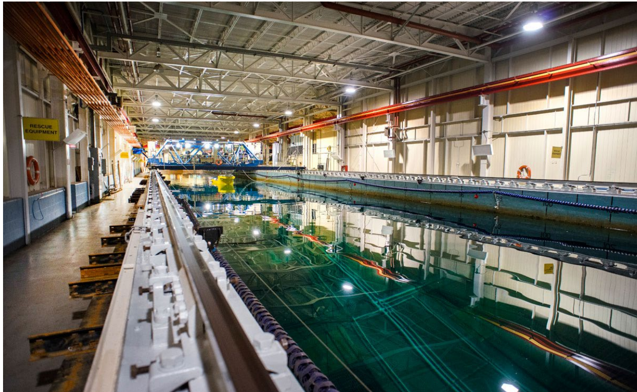
Figure 3 — Installation du réservoir à chariot mobile
