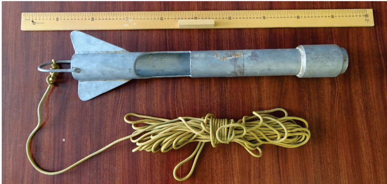
Figure 1. Échantillonneur de sédiments lacustres utilisé à la Commission géologique du Canada. L'appareil pèse 7,1 kg et prélève une carotte de 30 cm de sédiments lacustres, ce qui correspond à un poids de 1,2 kg de sédiments lacustres.
