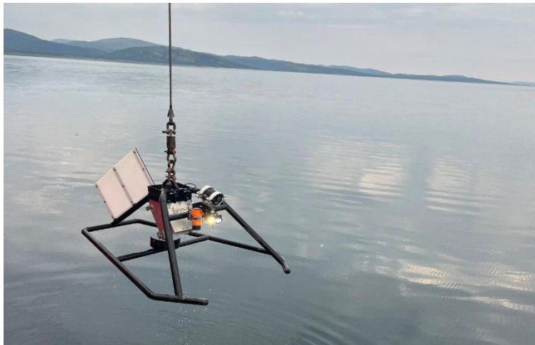
Figure 3. Fixation de la plateforme de la caméra immergée. Le poids est d'environ 500 livres.
