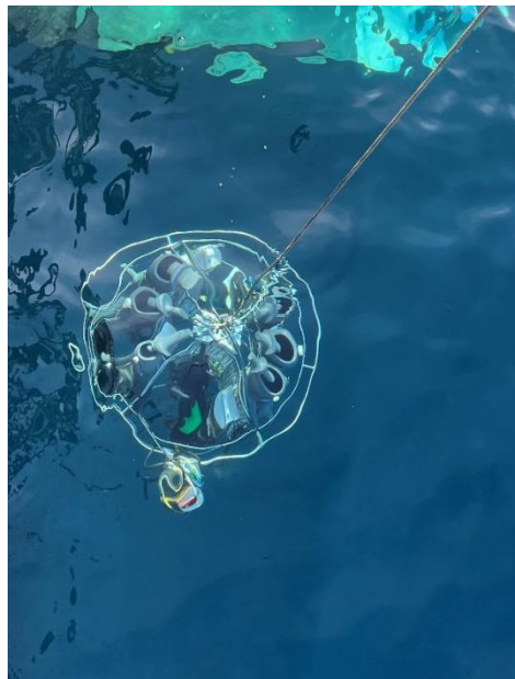
Figure 5. CTD-Rosette immergée sous la surface pour l'étalonnage.
