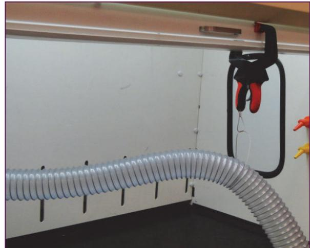
Figure A-8 : Canalisation de transfert de fumée
